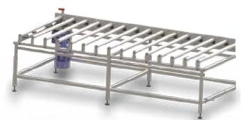
Rollenförderer für den horizontalen Transport von Türblättern oder Montageplatten. Stahlrollen, vulkanisiert mit Polyurethan. Abstand zwischen den Rollen 200 mm. Oberfläche - RAL 7035. Tragfähigkeit der Förderer 100 kg / 1 lfm Länge.
